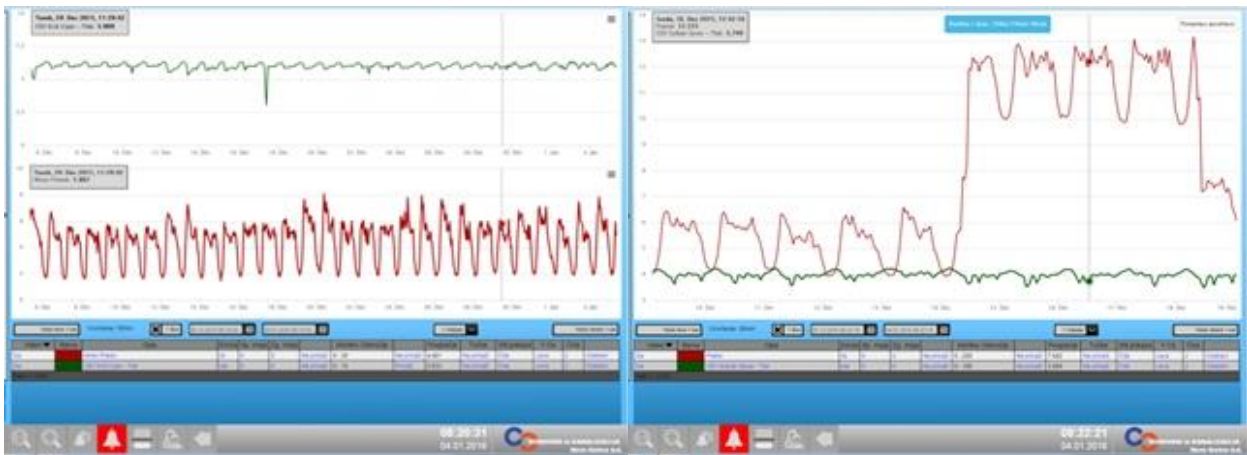
Slika 13: Primer pregleda meritev pretoka (rdeča) in tlaka (zelena) (levo) ter primer pregleda meritev pretoka in tlaka v primeru zapiranja ventilov (desno). V zaprto območje doteka celoten pretok skozi merilec (dvignjen graf) (Hvalič, 2016).
